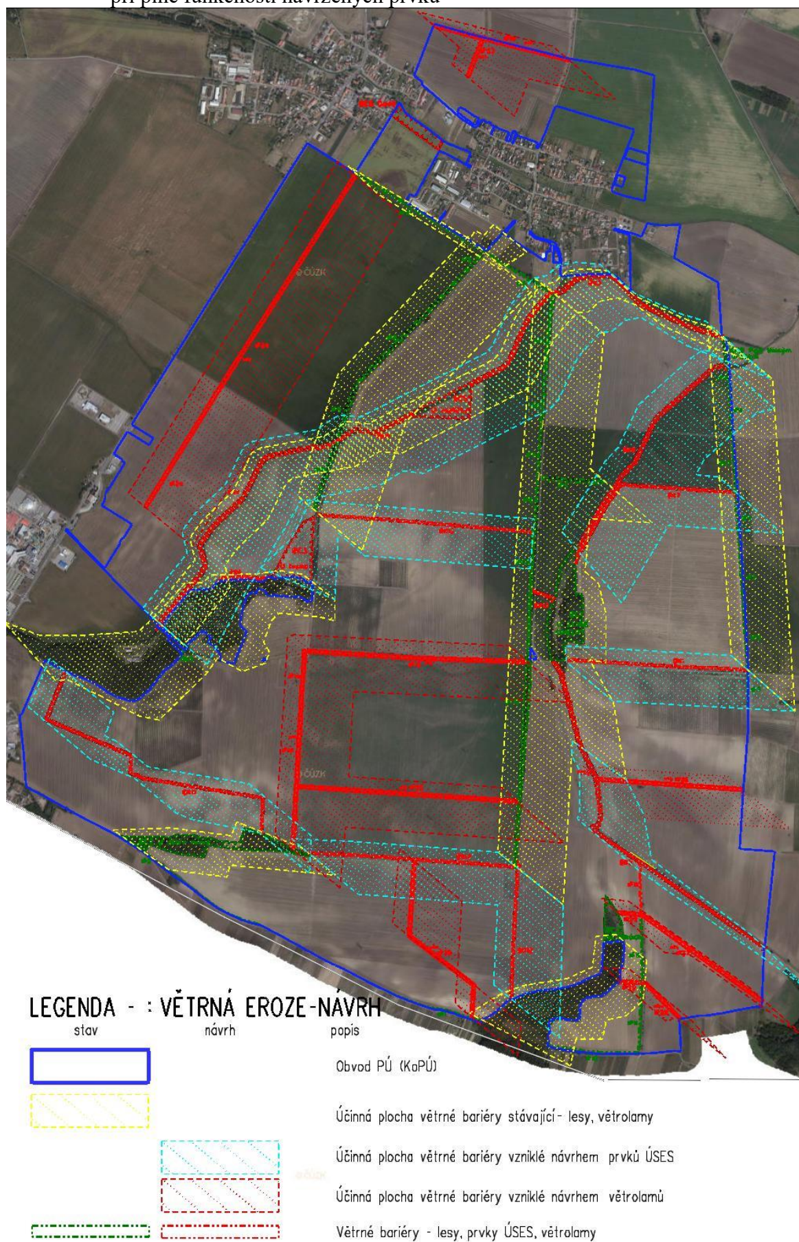
Obr. č. 4 Vyhodnocení účinnosti stávajících a nově navržených větrných bariér - větrolamů při plné funkčnosti navržených prvků
